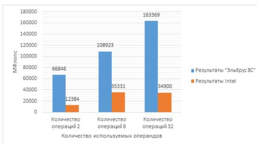
Рис. 2. Результаты теста «trmfloors» с использованием размера массива 1024000 элементов
