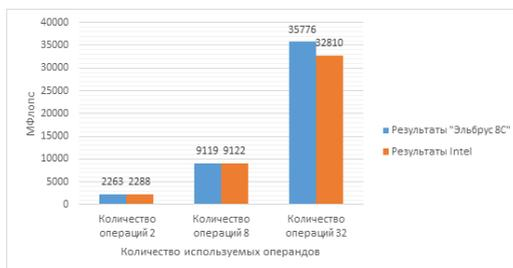
Рис. 3. Результаты теста «trmfloors» с использованием размера массива 10240000 элементов
